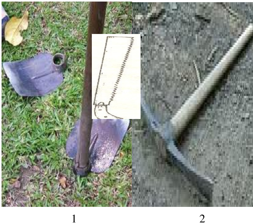
Hình 2.3.4: Dụng cụ dùng làm đất 1. Cuốc bàn 2. Cuốc chim
