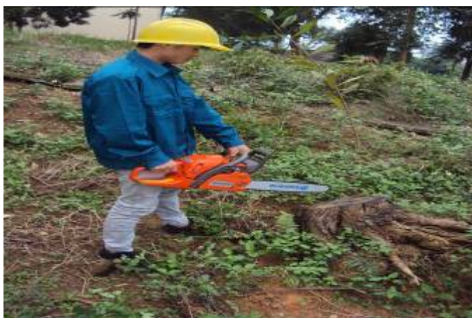
Hình 5.3.18: Kiểm tra sự bôi trơn xích cưa
