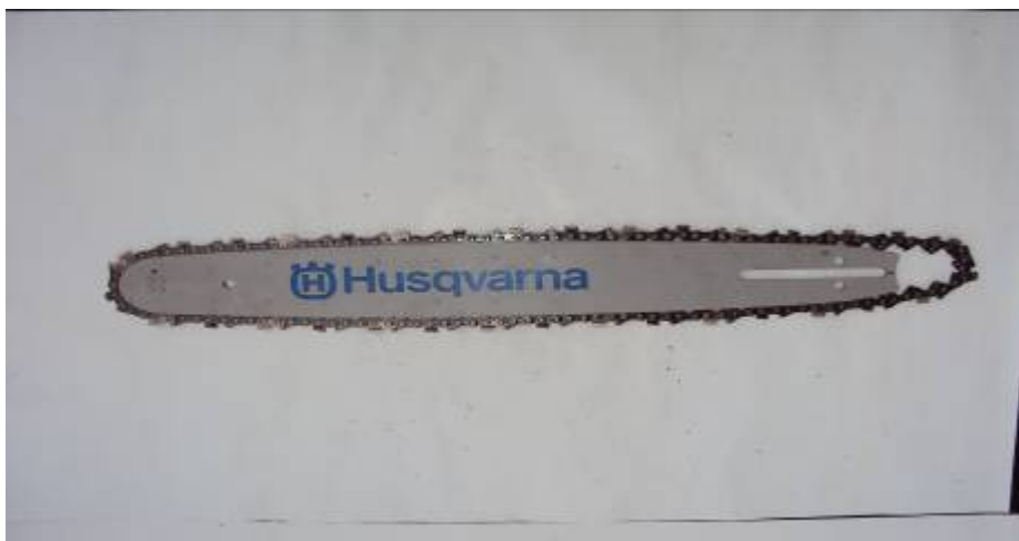
Hình 5.3.3: Cơ cấu cắt gỗ
