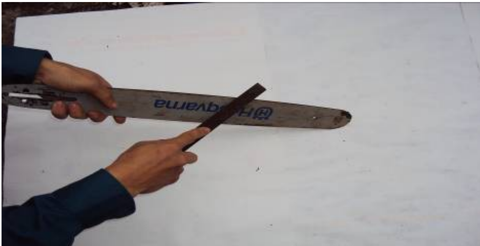
Hình 5.3.12: Dũa gờ sắc bản cưa
