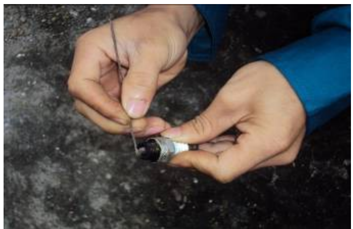
Hình 5.3.15: Làm sạch và điều chỉnh khe hở bu gi
