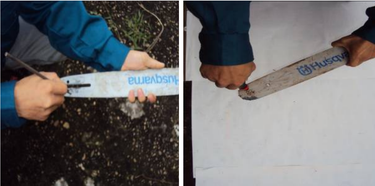
Hình 5.3.11: Làm sạch lỗ dẫn dầu và bơm mỡ cho bánh xích phụ động - Kiểm tra và dùng dũa phẳng, dũa bờ các gờ sắc bản cưa.
