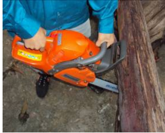
Hình 5.3.23: Cắt bằng phần xích chạy ra
