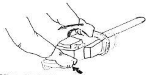
Hình 5.3.21: Điều khiển ga bằng ngón tay cái
