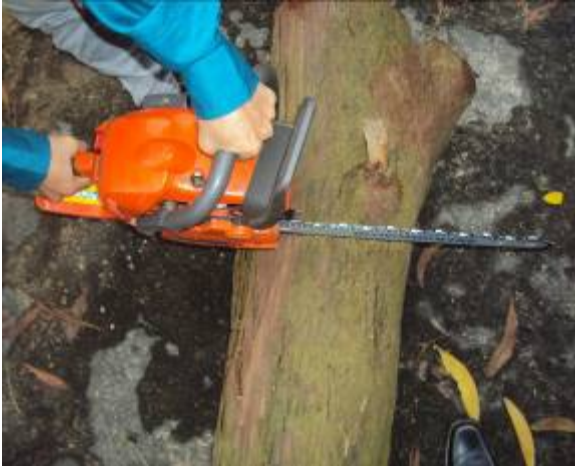
Hình 5.3.22: Cắt bằng phần xích chạy vào
