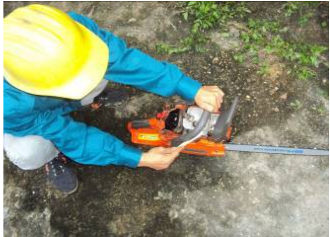
Hình 5.3.14: Làm sạch cánh quạt và cánh tản nhiệt
