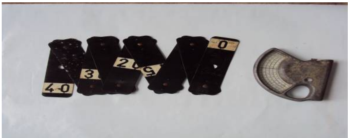
Hình 5.1.8: Cấu tạo thước Blumeleis
