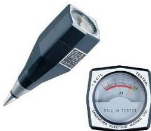
Hình 1.4.12: Thiết bị đo nhanh độ chua, độ ẩm đất
