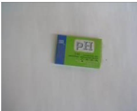
Hình 1.4.15: Giấy thử pH và bảng so màu xác định pH đất
