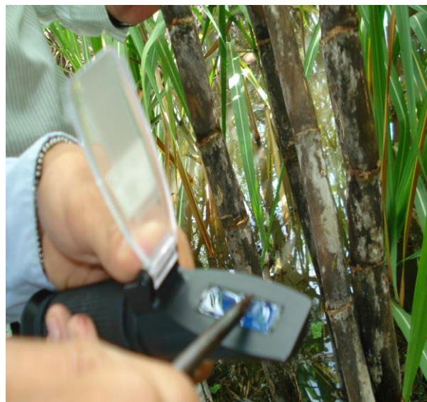
Hình 6.3: Nhỏ nước mía lên Brix kế để đo độ Brix
