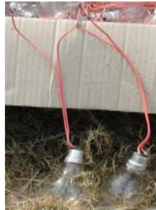
Hình 3.70. bóng đèn tròn 75W được hàn trực tiếp dây dẫn vào bóng đèn
