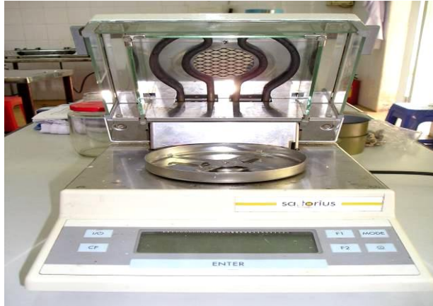
Hình 6.11. Máy kiểm tra độ ẩm nhanh
