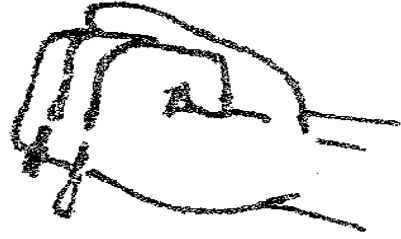
Hình 3.9. Mùn cưa thừa nước
