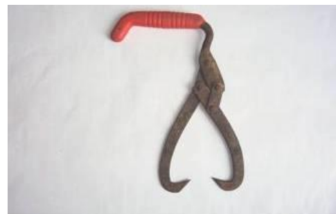
Hình 4.1.79: Móc xoay gỗ (1) Móc kép (2)
