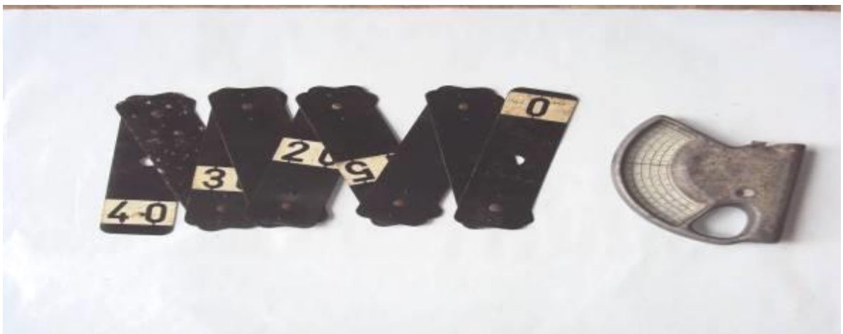
Hình 4.1.3: Cấu tạo thước Blumeleis
