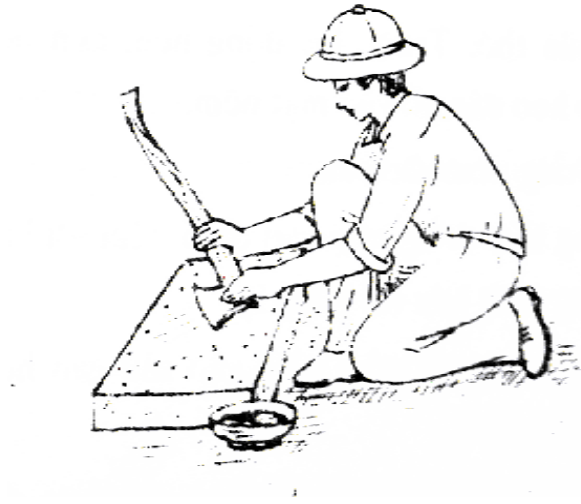
Hình 4.1.67: Mài búa bằng đá mài cố định
