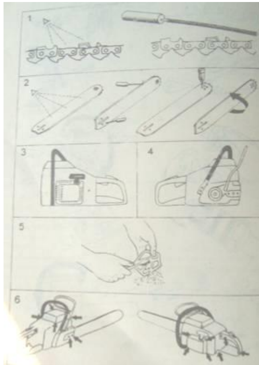
Hình 4.1.42: Trình tự công việc bảo dưỡng cưa xăng hàng ngày
