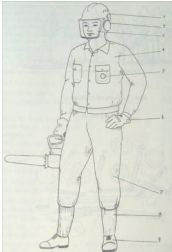
Hình 4.1.44: Trang bị bảo hộ lao động cho người sử dụng cưa xăng
