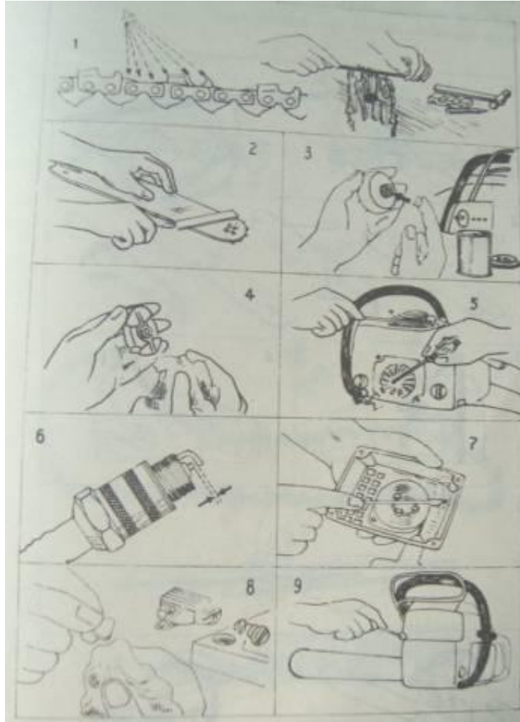
Hình 4.1.41: Trình tự công việc bảo dưỡng cưa xăng hàng tuần
