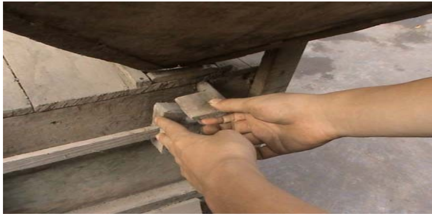
Hình 4.1.52. Mở bàn khóa giữa phễu và thùng làm sạch
