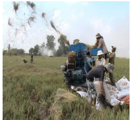
Hình 4.1.38. Điều khiển đưa lúa bông vào máy tuốt
