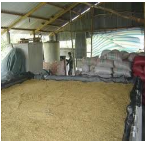
Hình 4.2.16. Trải lúa ra nền máy sấy
