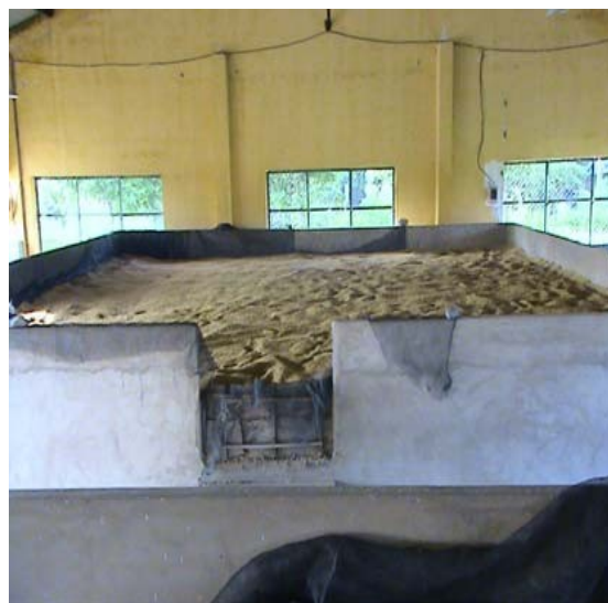
Hình 4.2.16. Trải lúa ra nền máy sấy
