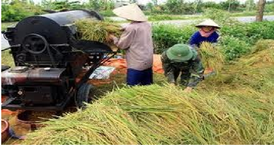
Hình 4.1.37. Đưa lúa bông lên máy tuốt
