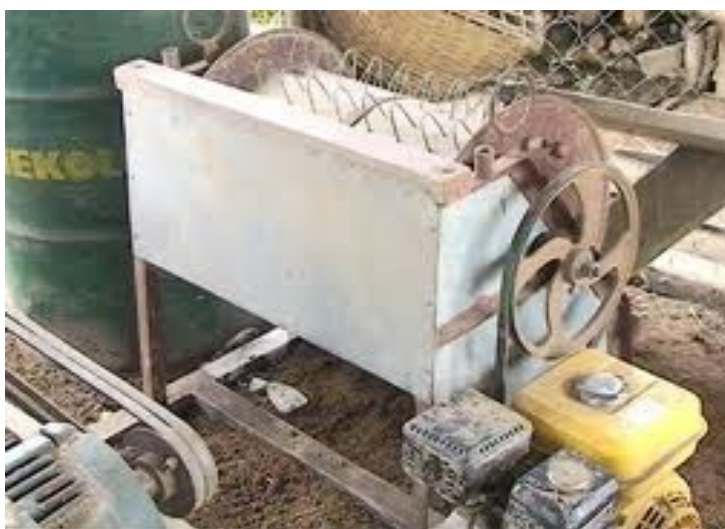
Hình 4.1.22. Dụng cụ tuốt lúa gắn động cơ
