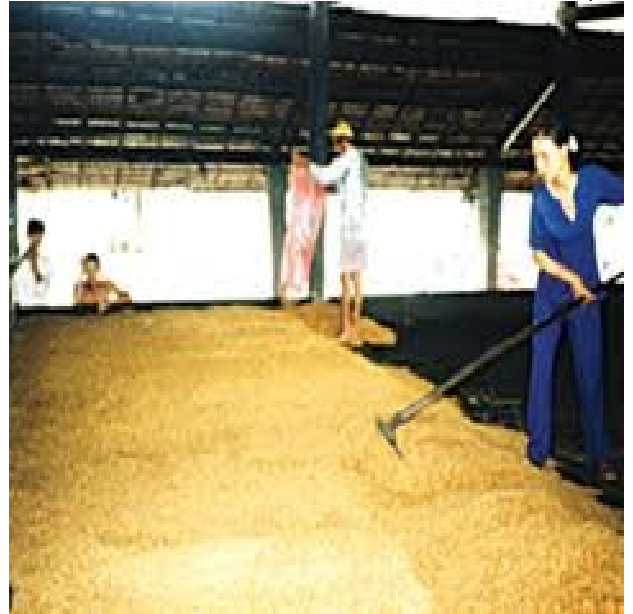
Hình 4.2.14. Đổ lần lượt lúa ướt ra nền lò sấy
