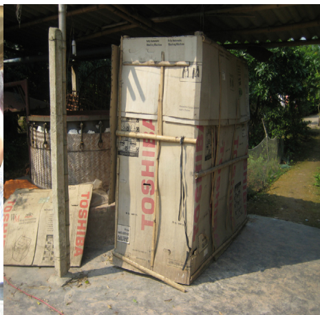
Hình 4. Lớp bao phủ lò sấy bằng bìa cát tông
