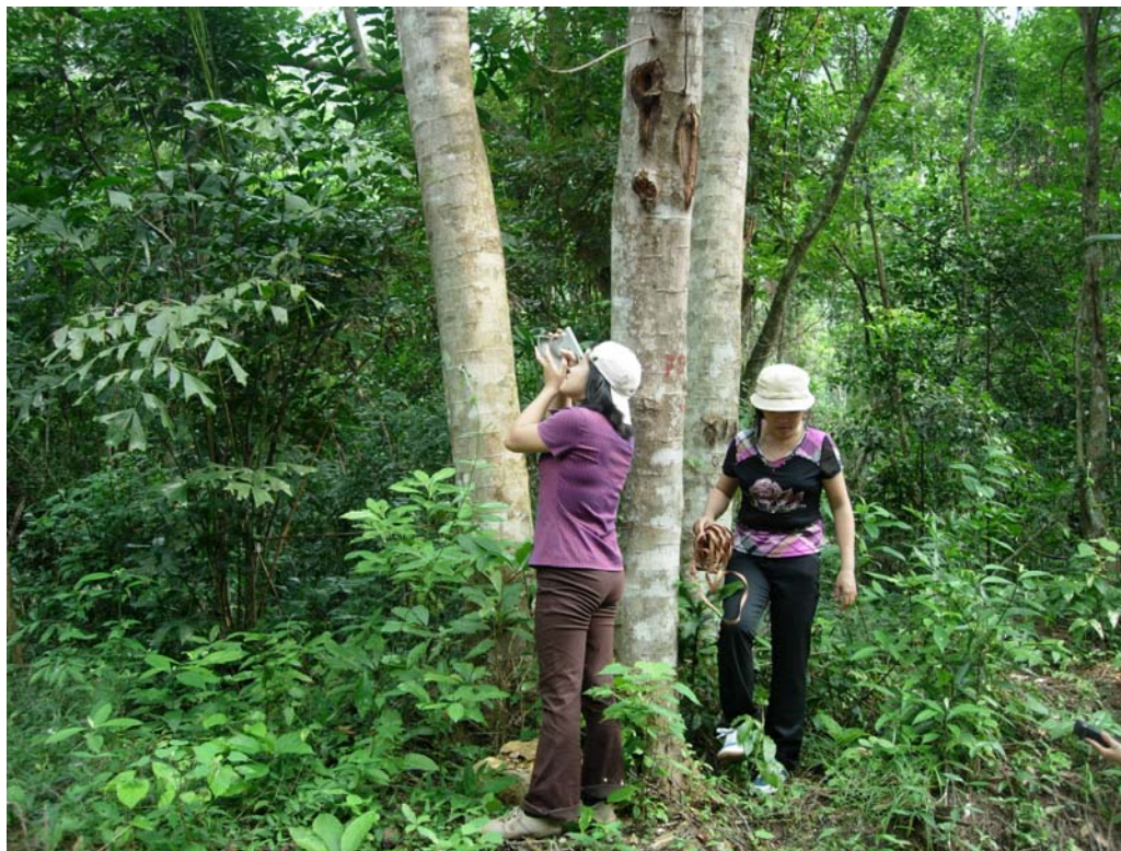
Ảnh 5: Đo chiều cao cây bằng thước Blume-leiss
