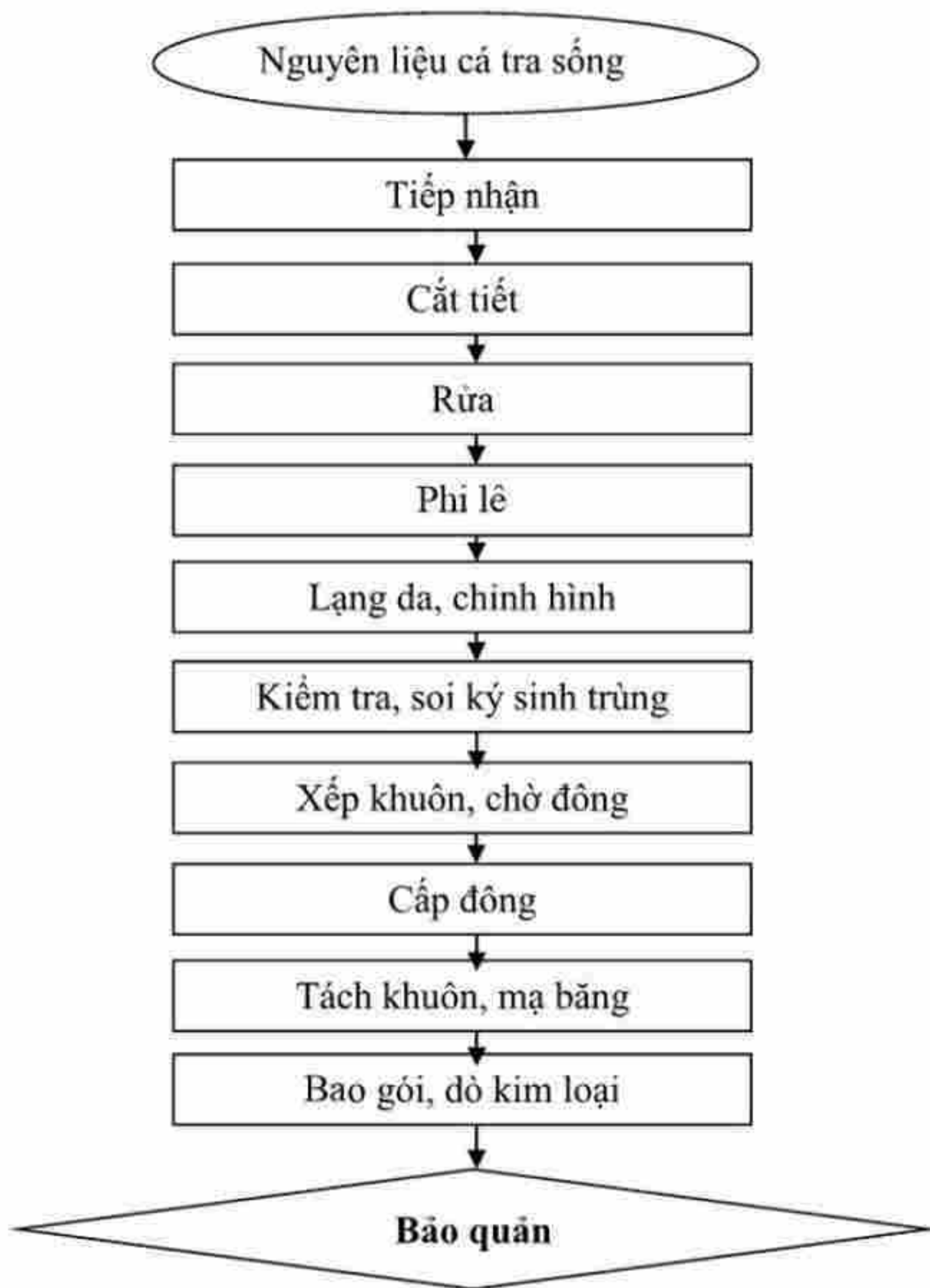
Hình 5.3: Quy trình công nghệ sản xuất cá tra phi lê đông lạnh
