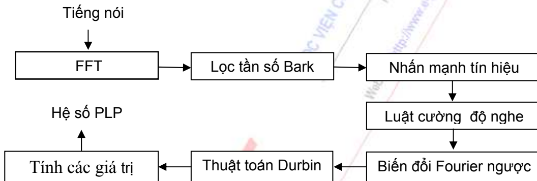
Hình 4.8. Sơ đồ các bước xác định hệ số PLP
