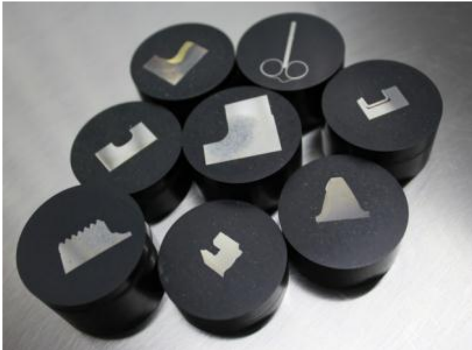
Hình 2.1: Mẫu kim tương được đúc trong khối chất lỏng. (chưa được mài và đánh bóng)
