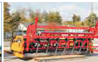
Máy rải bê tông tự động dạng trống lăn
