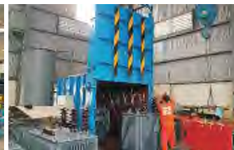
Thiết bị sấy - nạp dầu chân không cho máy biến áp
