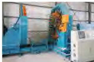
Máy hàn cốt thép ống bê tông điều khiển CNC
