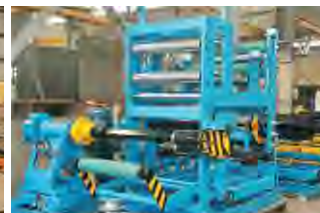
Máy quản đồng lá kép điều khiển PLC
