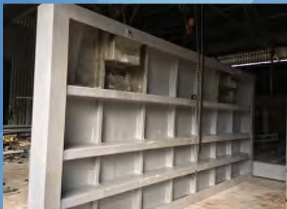
Sản phẩm vật liệu Composite (FRP) chế tạo van (cánh) công nghệ lõi - vật liệu nhúng, bền vững các tác nhân của môi trường.
