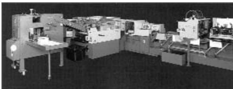
Hình 2.39: Hệ thống kết hợp giữa máy gấp, máy đóng kim, máy cắt 3 mặt, máy đóng gói để cho ra sản phẩm là Brochure.
