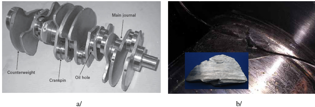
Hình 21. Trục khuỷu động cơ 4 kì (a) và vết nứt trên cổ trục (b).
