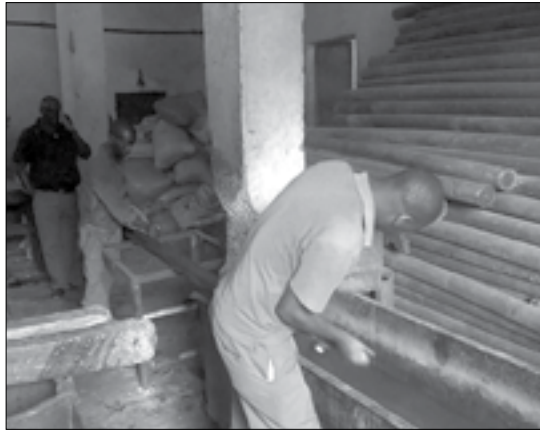
▲ Công nhân Công ty Năng lượng tái tạo lục địa với những sản phẩm cọc từ RTN tái chế
