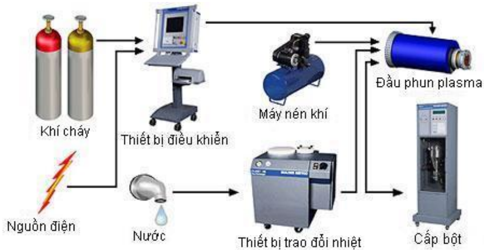
H 3.13 . Thiết bị phun plasma hệ hở
