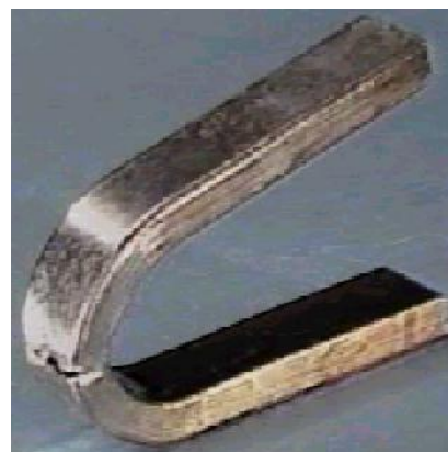
Hình 2.8- Thí nghiệm thử uốn và quan sát vết nứt
