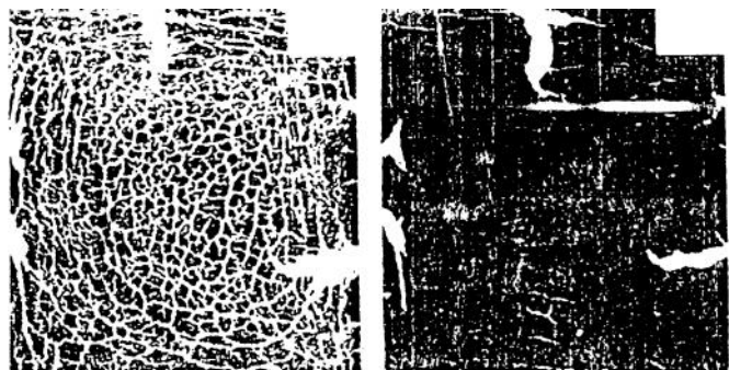
Hình 4.2. Các chỉ thị giả do làm sạch bằng cơ khí
