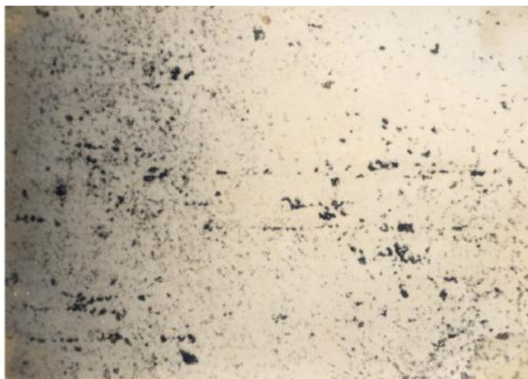
Hình 9.3 Tổ chức tế vi của đũa sau nhiệt luyện
