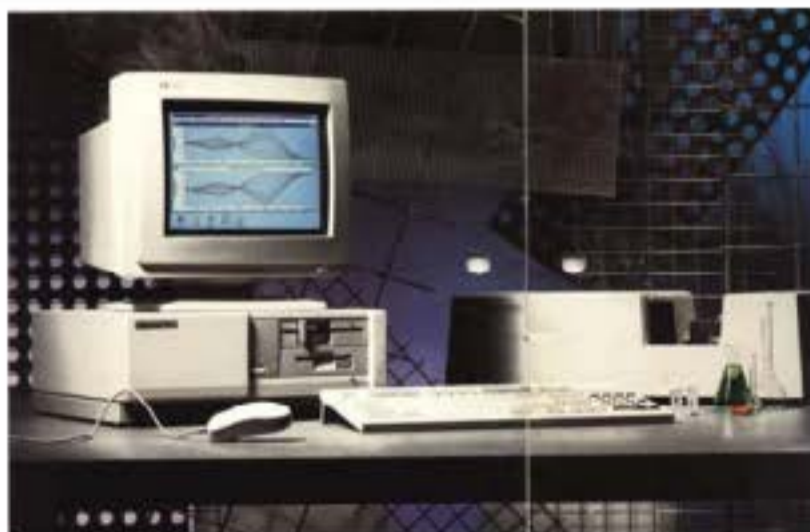
Hình 24b. Phổ kế tử ngoại khả kiến của hãng HEWLETT PACKAR (HP 8542, Diode-array)
