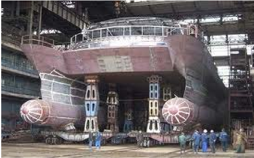
Hình 2.17 Chế tạo tàu SWATH
