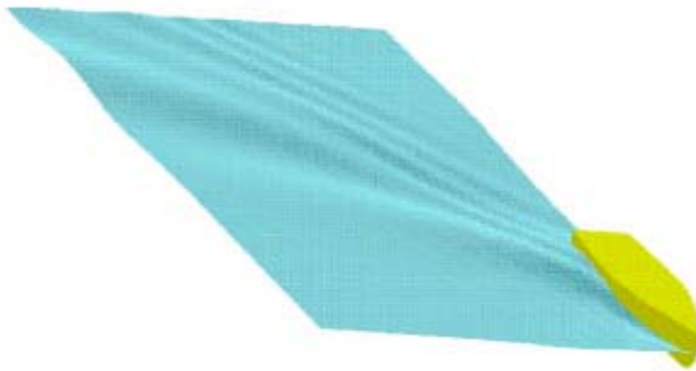
Hình 3.7 Sóng quanh thân tàu tính bằng CFD
