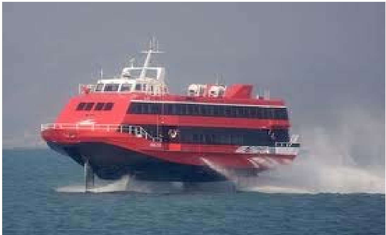
Hình 2.34 Tàu cao tốc sử dụng waterjet “Jetfoil 3”
