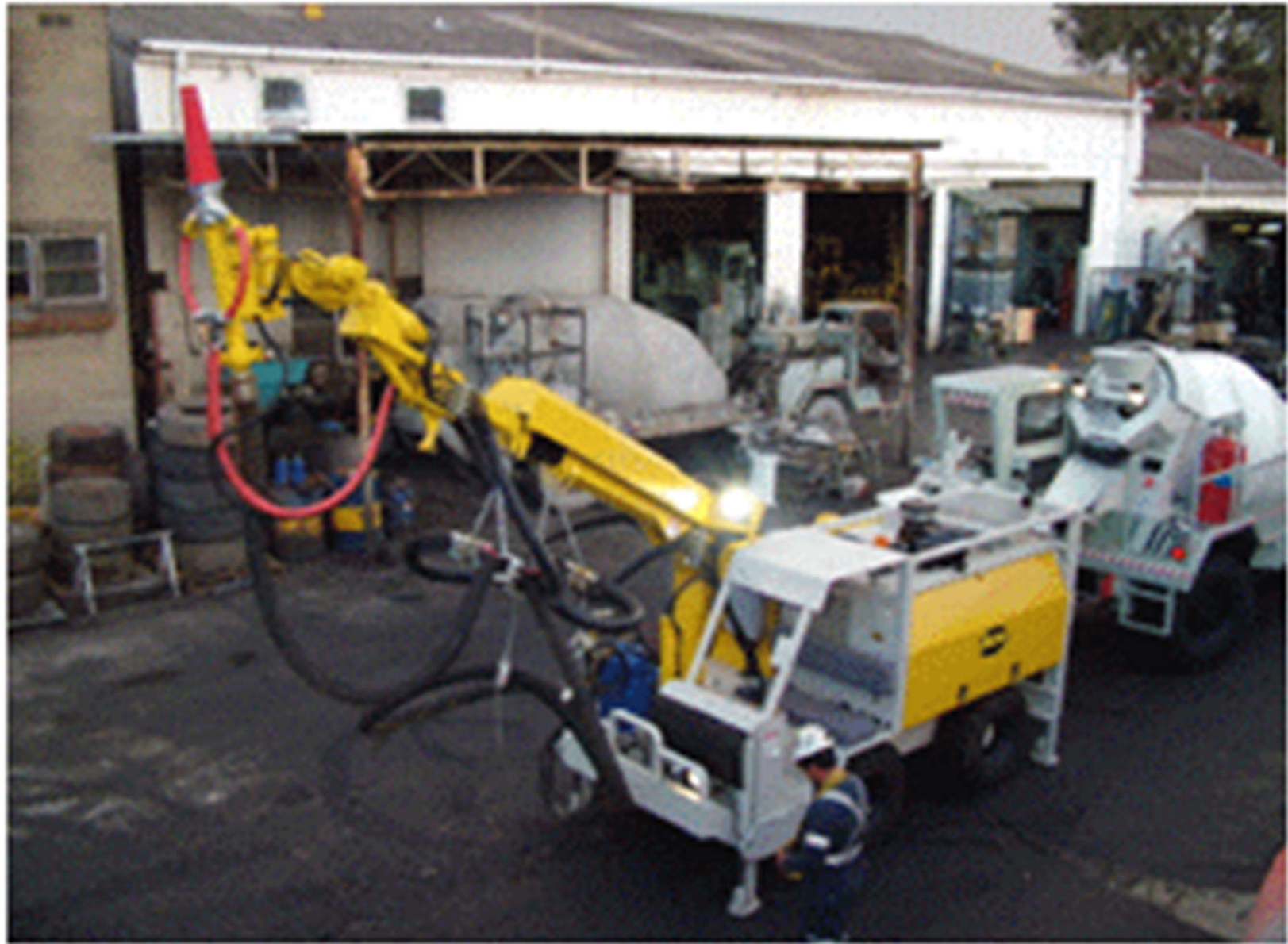
Hình 12. Robot phun bê tông Jacon (Australia) của Cty SĐ 10
