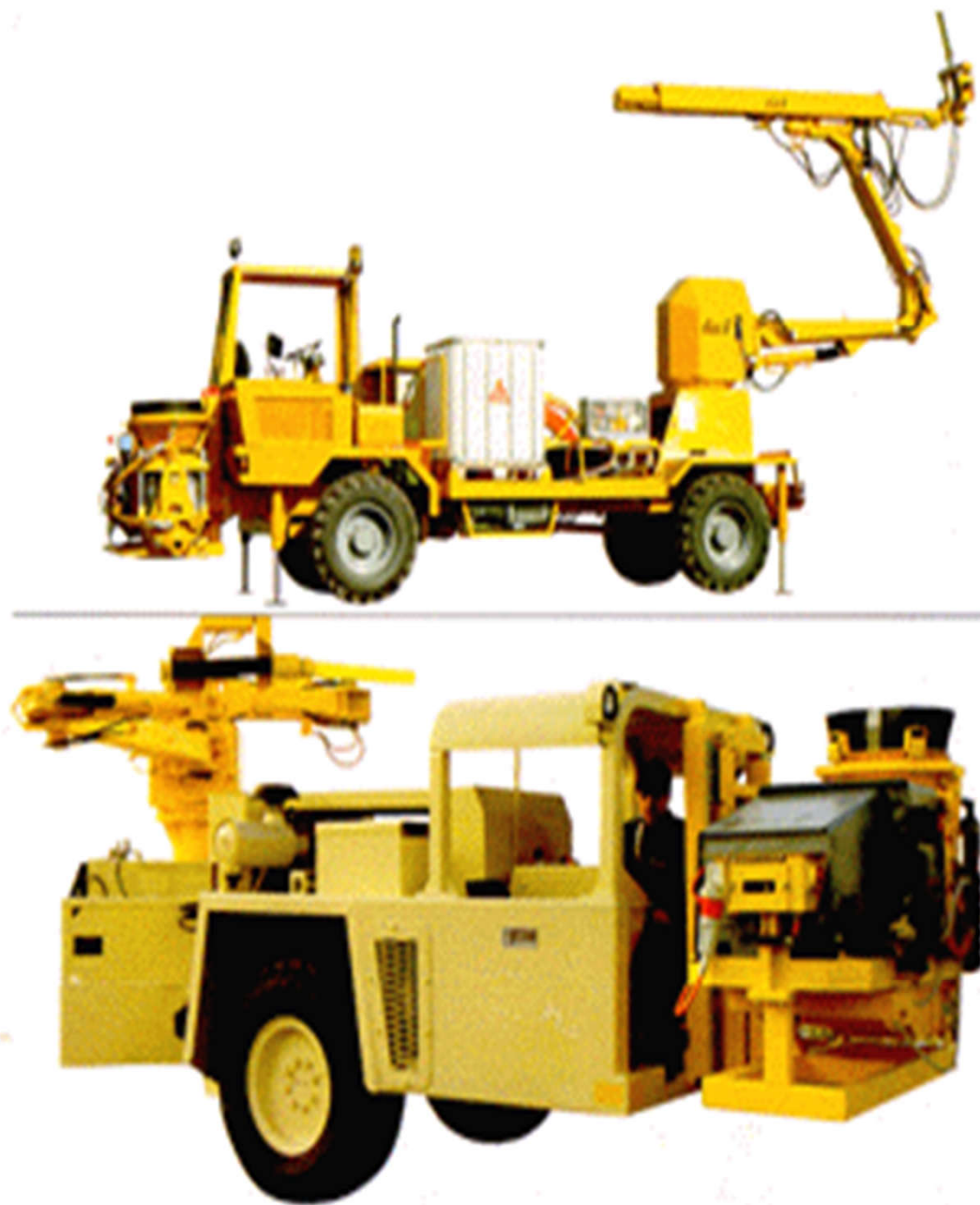
Hình 11. Máy phun Aliva 500 (Cty SĐ 10) sử dụng tại công trình hầm đèo đường bộ Hải Vân
