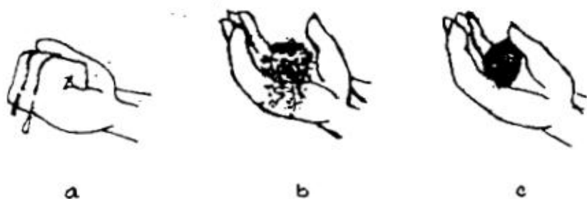
Hình 14: Cách thử độ ẩm của mặt cưa a. Dư nước c. Thiếu nước b. Đủ nước
