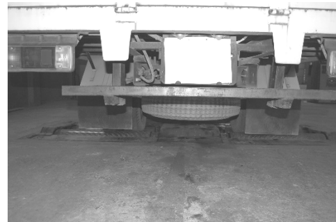
Hình 5. Kiểm tra phanh trên bộ thử
