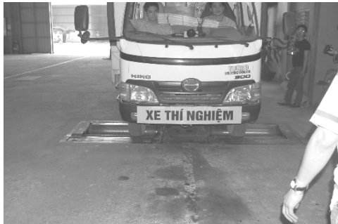
Hình 5. Kiểm tra phanh trên bộ thử
