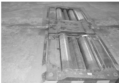
Hình 4. Bộ thử phanh IW4 của hãng MAHA
