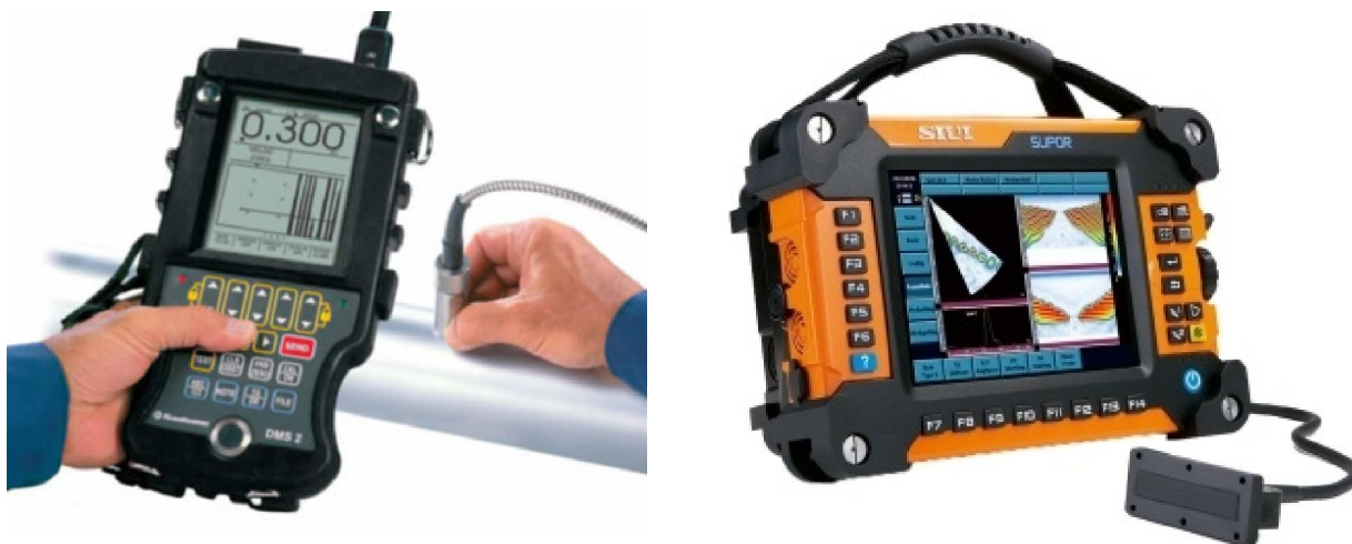
Hình 15. Thiết bị kiểm tra UT
