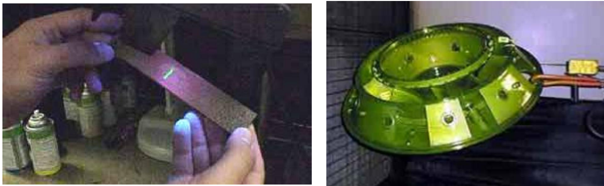
Hình 9. Một số hình ảnh minh họa phương pháp kiểm tra thẩm thấu PT
