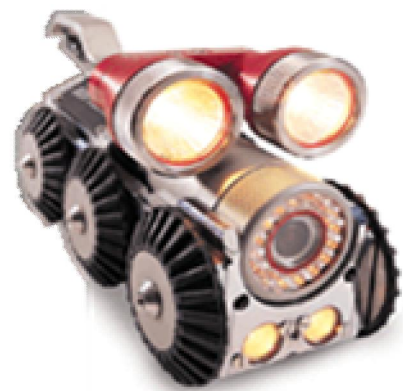
Hình 1. Hệ thống nội soi vô tuyến xách tay với chức năng zoom cho phép kiểm tra các bồn bể bình lớn, toa xe bồn, các chi tiết máy móc động cơ khó tiếp cận
