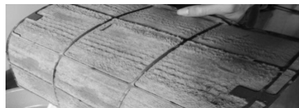
Hình 10. Tắm lọc bụi điều hòa bản
