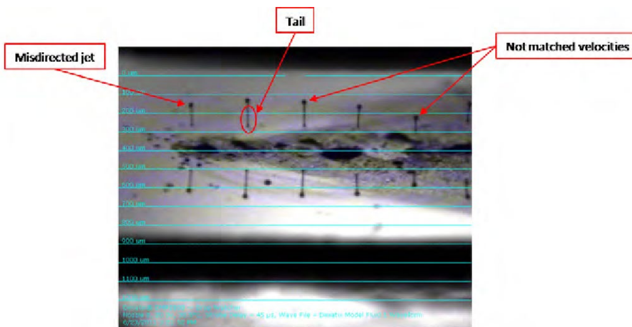
Hình 3.13 Các giọt mực bị lỗi: sai hướng, đuôi mực và tốc độ không đạt.
