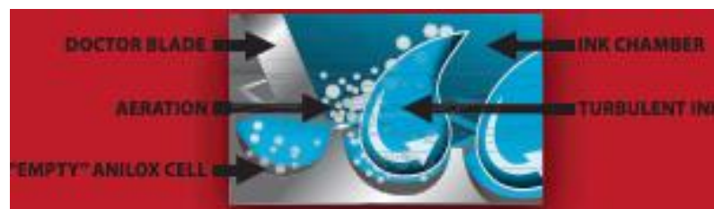
Hình 3.18 Mô tả giọt mực trên trục Anilox truyền thống
