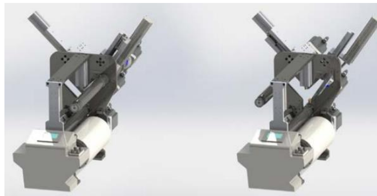
Hình 3.6 Hệ thống thay bản cấu hình V Flower Unit
