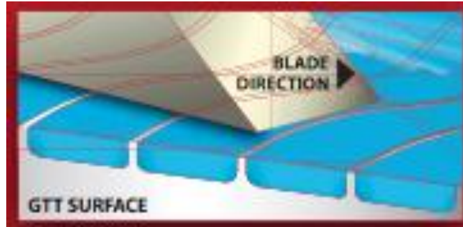
Hình 3.15 Mô tả lượng mực ổn định của trục Anilox GTT khi tiếp xúc dao gạt
