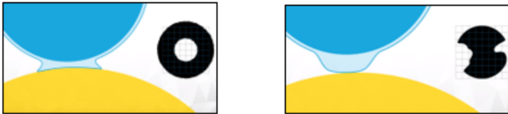
Hình 3.3 Dư hoặc thiếu áp lực in khiến điểm tram bị biến dạng
