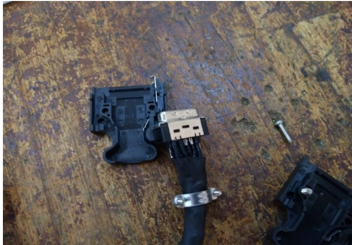
Hình 4.17 Jack cắm encoder của driver MR-J3B
