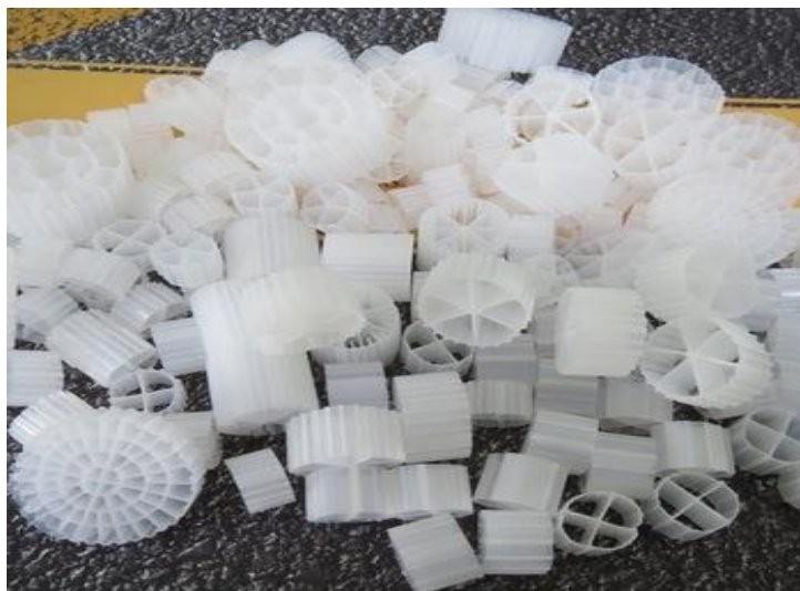
Hình 1.12. Vật liệu lọc MBBR
