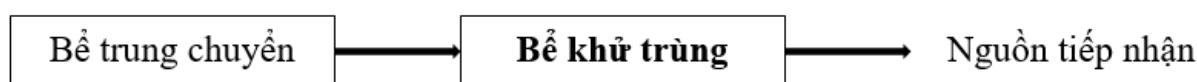
Hình 3.23. Sơ đồ khối các công trình đơn vị trước và sau bể khử trùng
