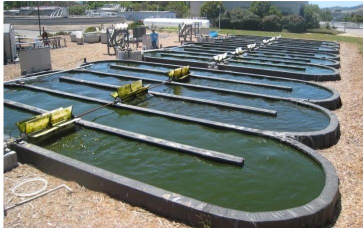
Hình 1.6: Hệ thống hồ nuôi tảo mật độ cao HRAPs [45]
