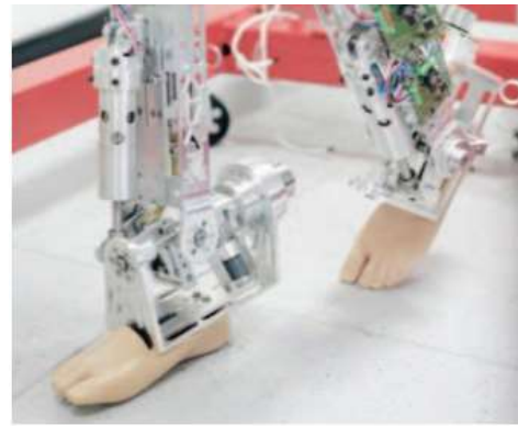
Hình 2.4. Hệ thống chân-mắt cá chân 2-bậc tự do dựa trên cơ cấu mềm [39]
