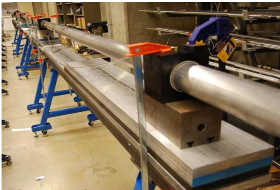
Hình 0.1. Thiết bị Split Hopkinson Pressure Bar (SHPB) đường kính 75 mm
