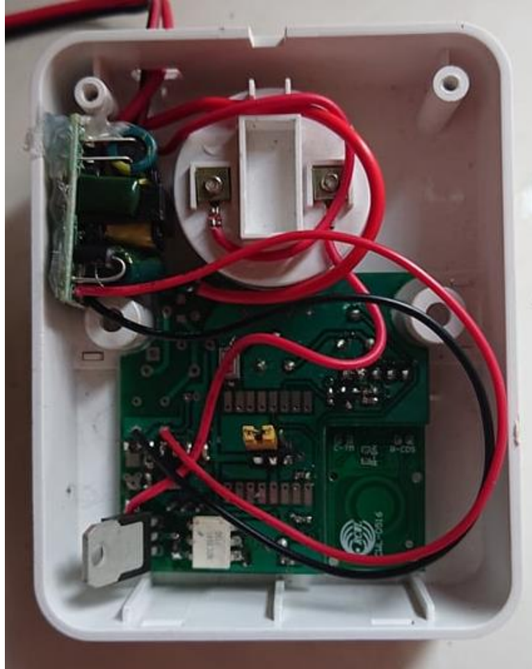
Hình 4. 8: Board mạch sau khi được cho vào hộp đèn
