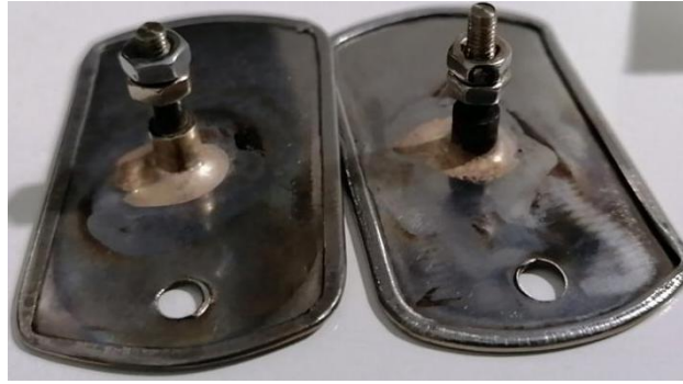
Hình 3.11: Tấm Inox làm điện cực
