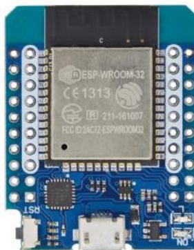
Hình 3.12: Module MH ET LIVE ESP32 MINIKIT
