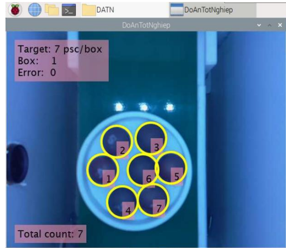
Hình 5.14: Kết quả chụp từ camera (7 viên) Hình 5.15: Kết quả sau khi xử lý (7 viên)
