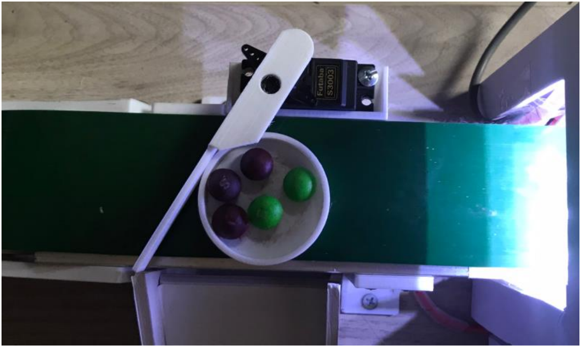
Hình 4. 32: Số lượng kẹo sai thì servo tác động kẹo xuống máng Hệ thống sẽ thoát khi công tắc chuyển sang trạng thái OFF.
