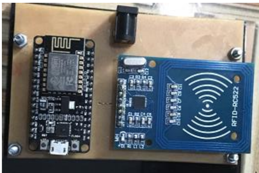
Hình 4.5. Mặt trên board của trạm y tế khi lắp linh kiện
