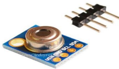
Hình 2.7. Module cảm biến nhiệt độ hồng ngoại không tiếp xúc MLX90614
