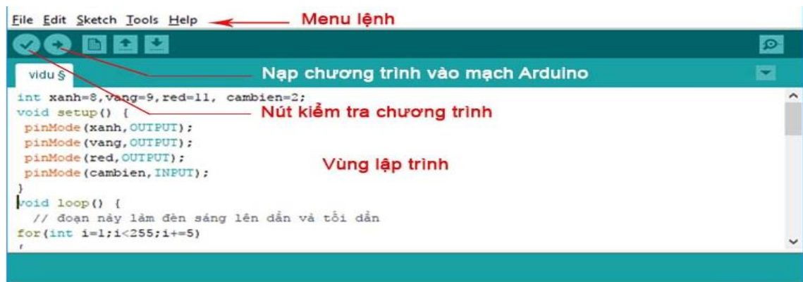
Hình 2.17. Giao diện lập trình và các chức năng của Arduino IDE
