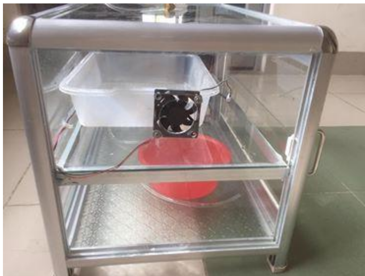
Hình 4-6: Mô hình tủ nhìn từ một bên hông, với cánh quạt thông gió.
