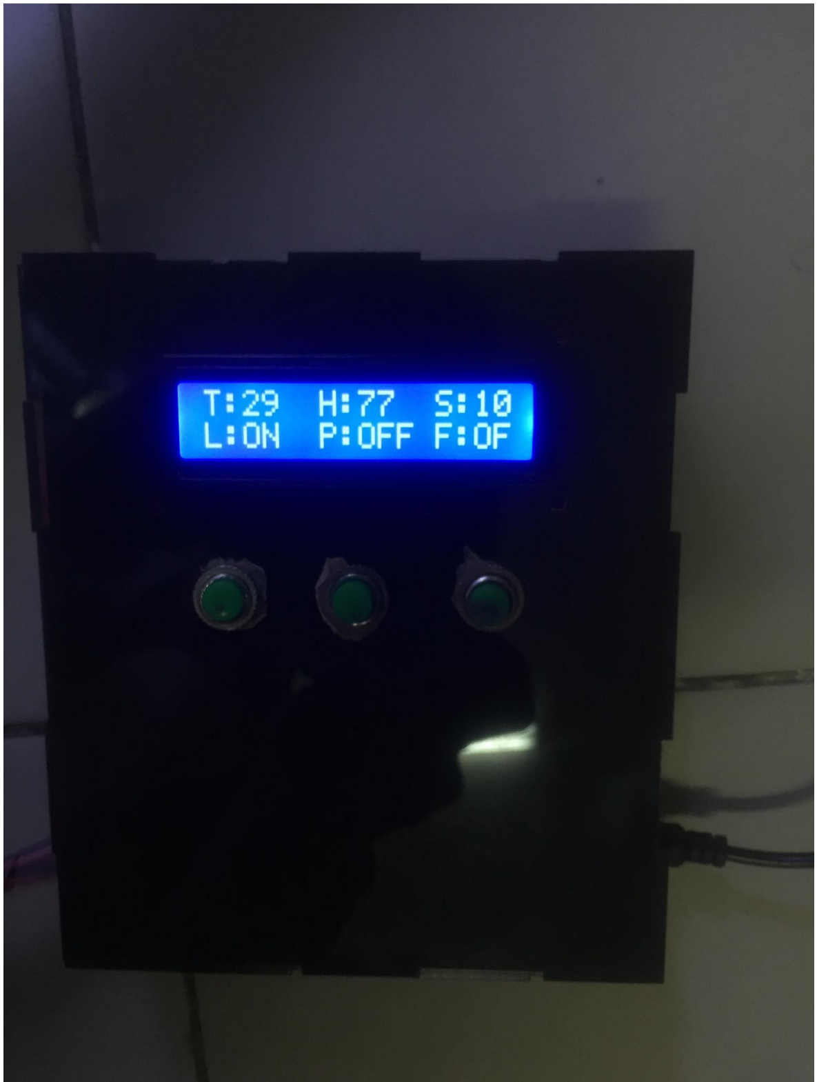
Hình 5-4: Trạng thái các thiết bị và thông tin cảm biến được hiển thị trên.
