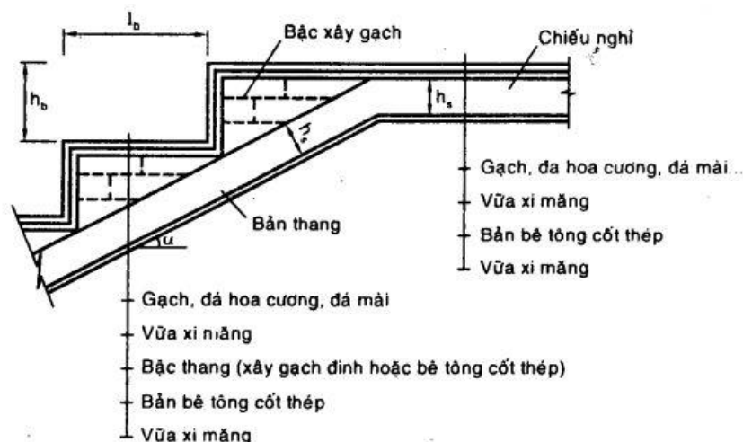
Hình 3.2 Các lớp cấu tạo cầu thang
