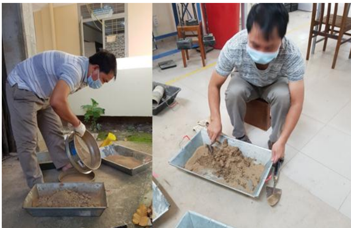
Hình 2.14: Chuẩn bị mẫu thí nghiệm xác định giới hạn dẻo và giới hạn chảy trong phòng thí nghiệm theo TCVN 4197:2012.
