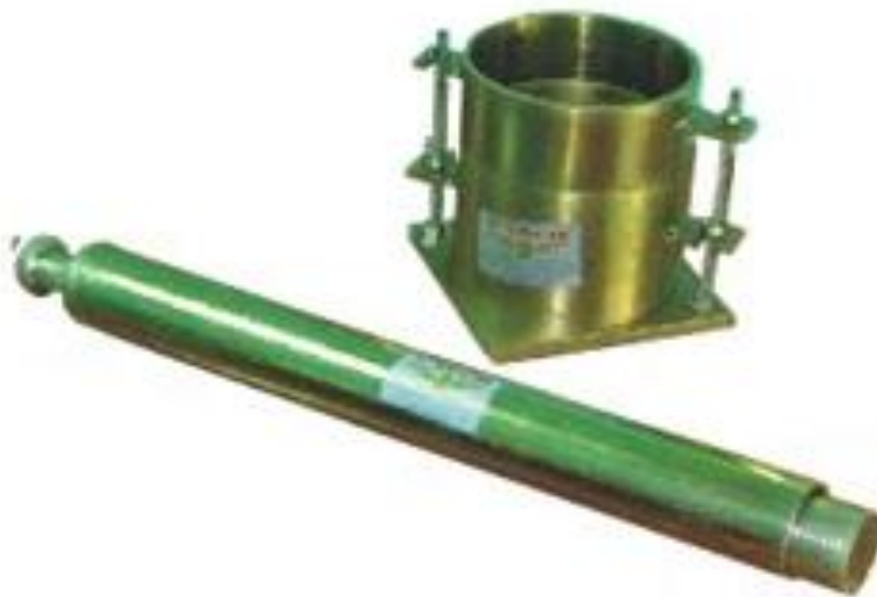
Hình 2.4: Bộ cối chày đầm Proctor tiêu chuẩn trong thí nghiệm nhằm xác định giá trị độ ẩm đầm nén tốt nhất và khối lượng thể tích khô lớn nhất của vật liệu như đất.
