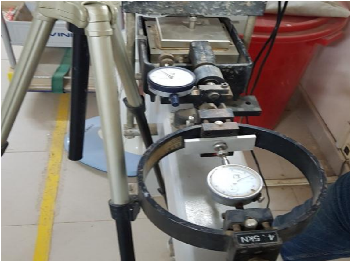
Hình 2.15: Thí nghiệm xác định sức chống cắt trong phòng thí nghiệm ở máy cắt phẳng (TCVN 4199 : 1995).
