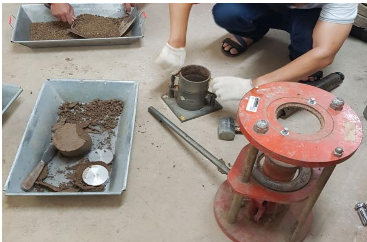
Hình 2.13: Các thao tác Chuẩn bị mẫu thí nghiệm xác định giá trị độ ẩm đầm nén tốt nhất và khối lượng thể tích khô lớn nhất theo 22TCN 333:06. (Quy trình đầm nén đất, đá dăm trong phòng thí nghiệm).
