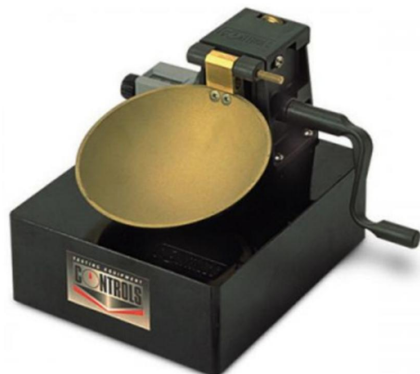
Hình 2.3: Thiết bị của Casagrande để xác định giới hạn chảy
