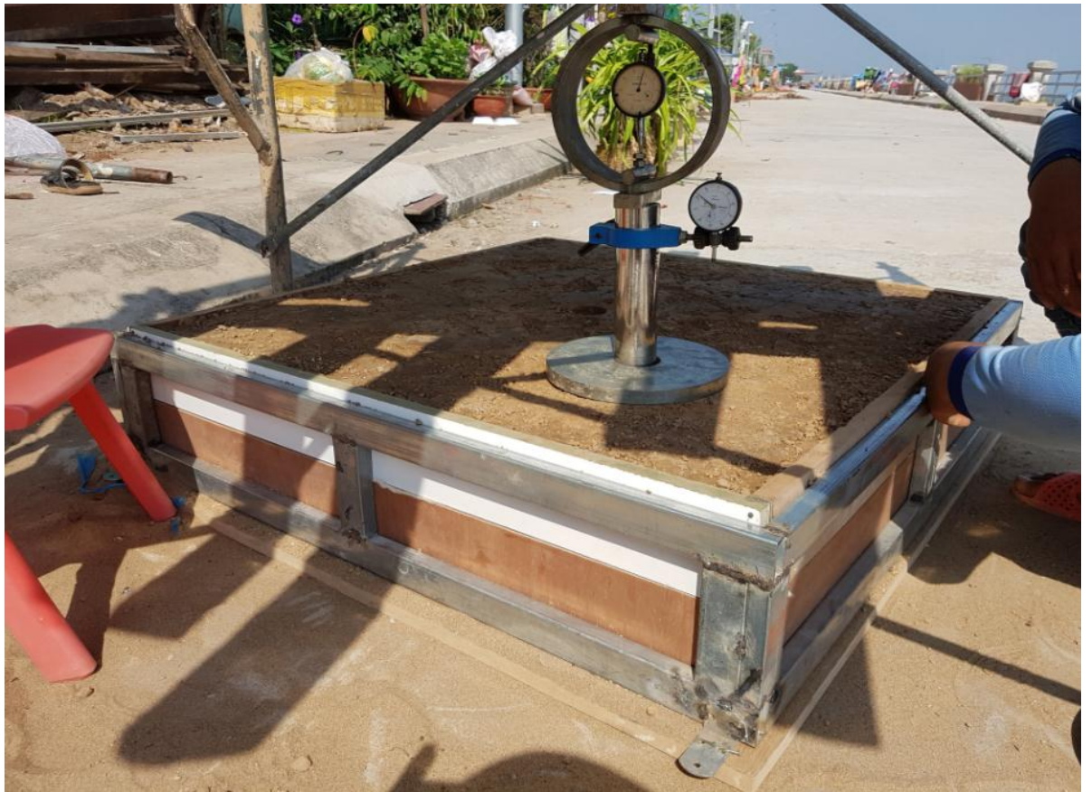
Hình 2.18: Kết thúc một lần nén thí nghiệm CBR hiện trường.
