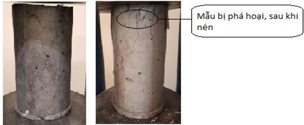
Hình 4.1. Mẫu quan sát thí nghiệm cường độ chịu nén.
