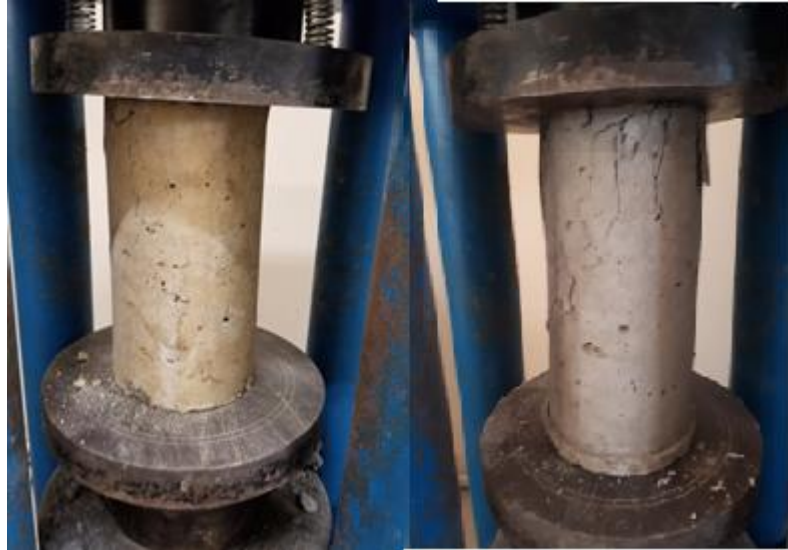
Hình 3.15. Thí nghiệm nén mẫu, để xác định cường độ chịu nén.
