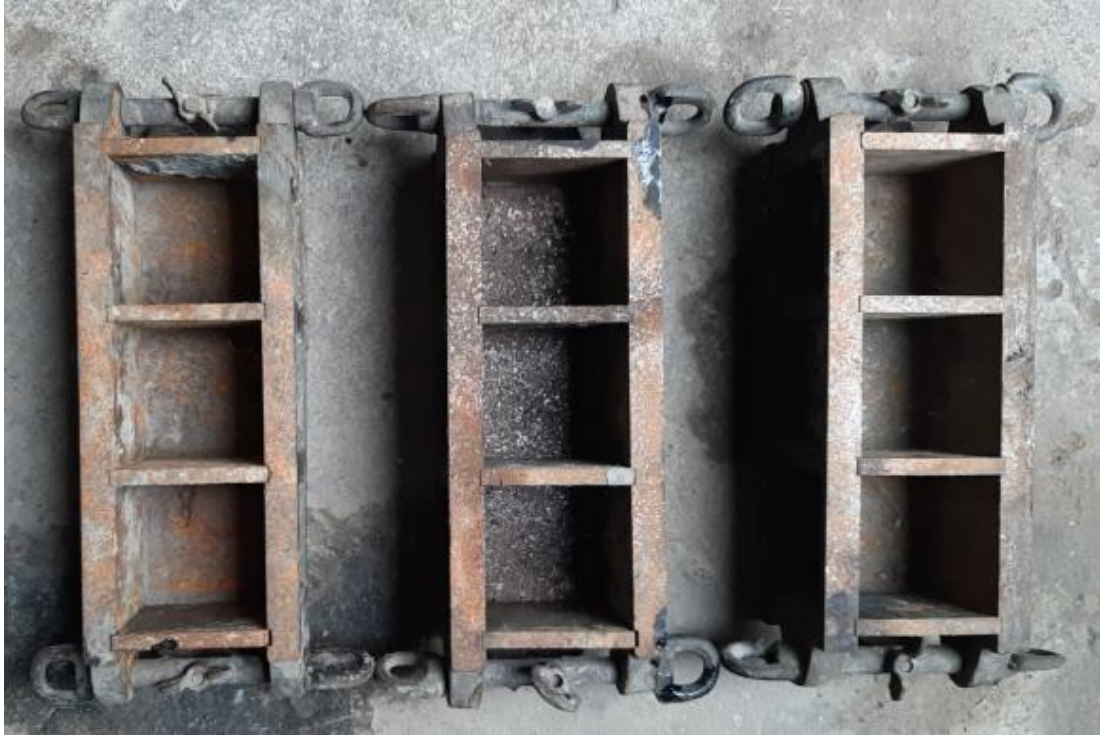
Hình 3.17. Mẫu lập phương 70,7mm - thí nghiệm xác định độ mài mòn.
