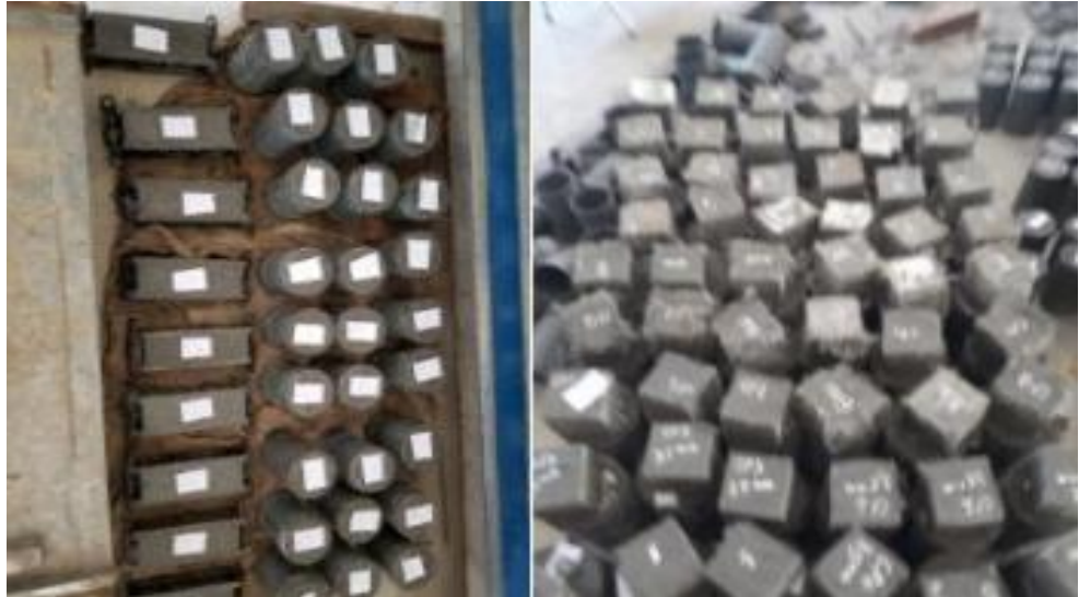
Hình 3.12. Mẫu bê tông sau khi đúc và tháo dỡ mẫu.
