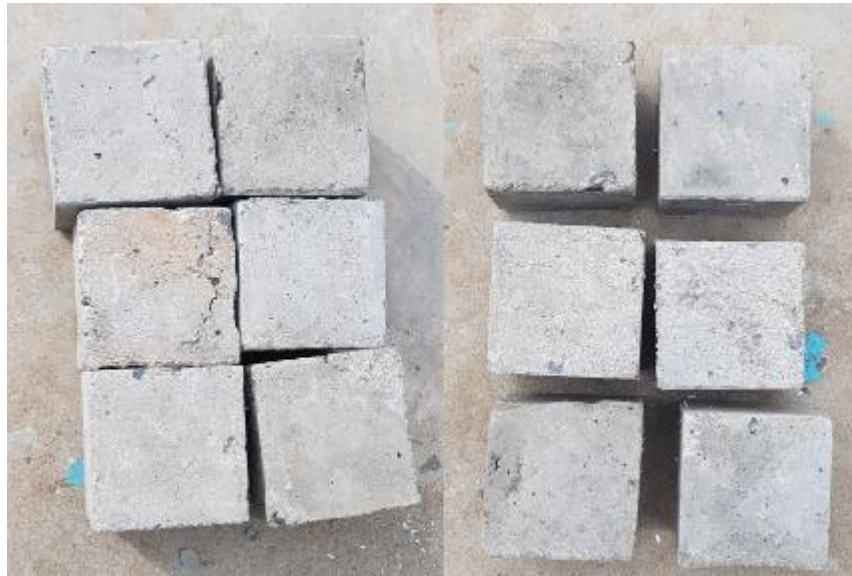
Hình 3.21. Kết quả mẫu trước (1) và sau khi mài mòn (2).
