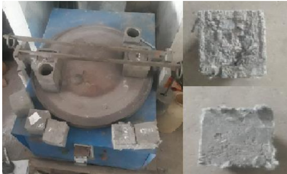
Hình 3.22. Thí nghiệm mài mòn và mẫu thí nghiệm trước, sau khi mài mòn.
