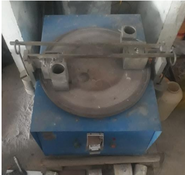
Hình 3.18. Máy mài mòn T-Tech (TC ISO 9001:2018).
