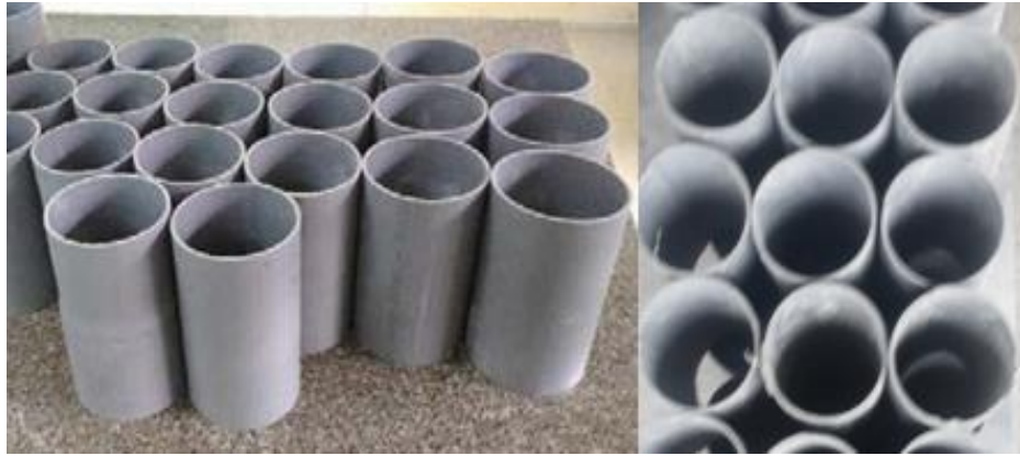
Hình 3.10. Mẫu hình trụ 100x200mm, thí nghiệm xác định cường độ chịu nén.
