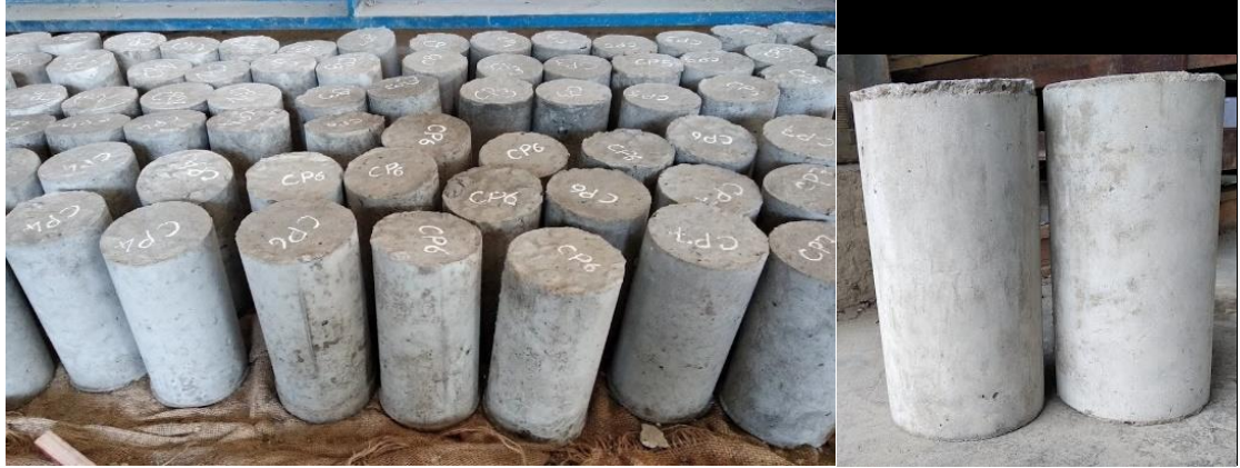
Hình 3.10: Mẫu bê tông sau khi được dưỡng hộ
