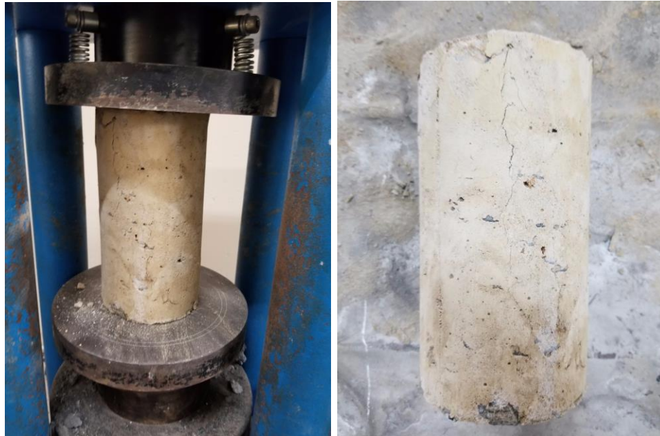
Hình 4.4: Nén mẫu bê tông
