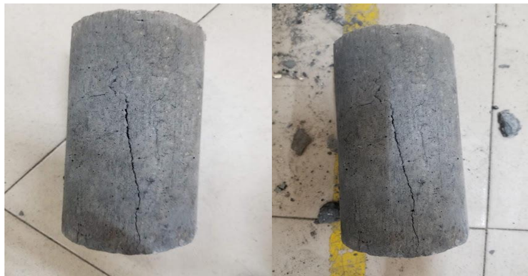
Hình 3.18 Mẫu được nén phá hủy
