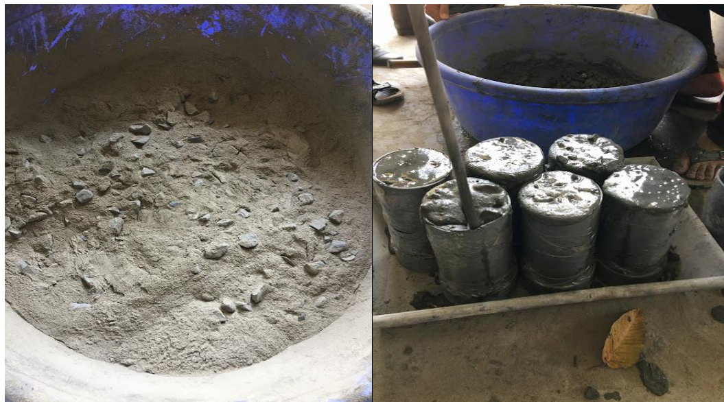
Hình 3.11 Hỗn hợp sau khi trộn khô và đúc mẫu
