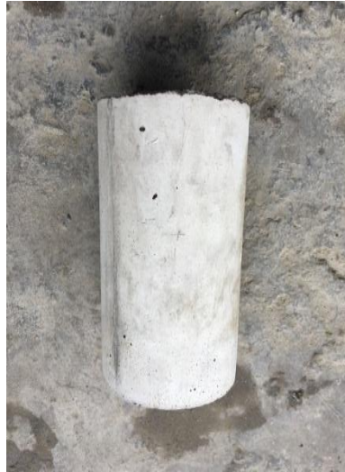
Mẫu trước khi ngâm hóa chất Ngâm trong dung dịch HCl
