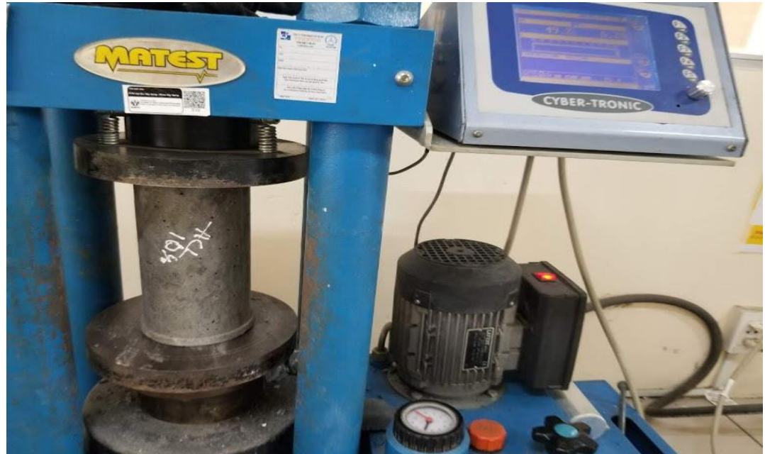
Hình 3.17 Thí nghiệm nén mẫu
