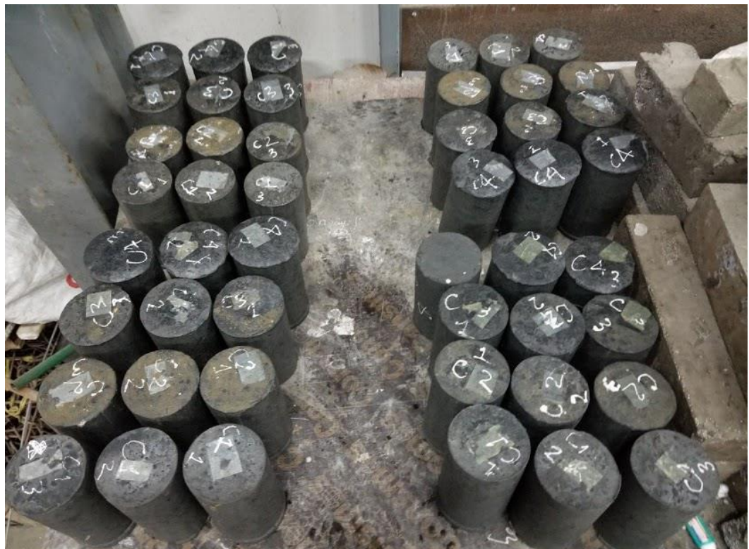
Hình 4.1 Các mẫu bê tông geopolymer được lấy ra sau khi ngâm hóa chất sau thời gian 120 ngày
