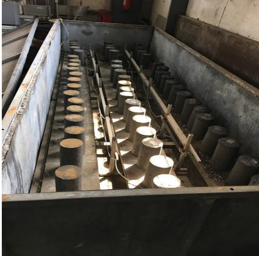
Hình 3.13 Dưỡng hộ nhiệt các mẫu bê tông Geopolymer bằng lò sấy
