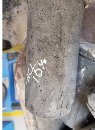
Mẫu trước khi ngâm hóa chất Ngâm trong dung dịch HCl
