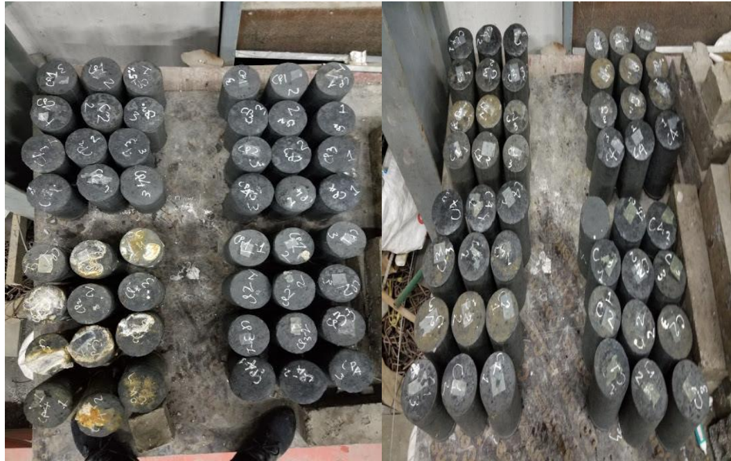
Hình 3.16 Mẫu bê tông Geopolymer được lấy ra khỏi dung dịch hóa chất
