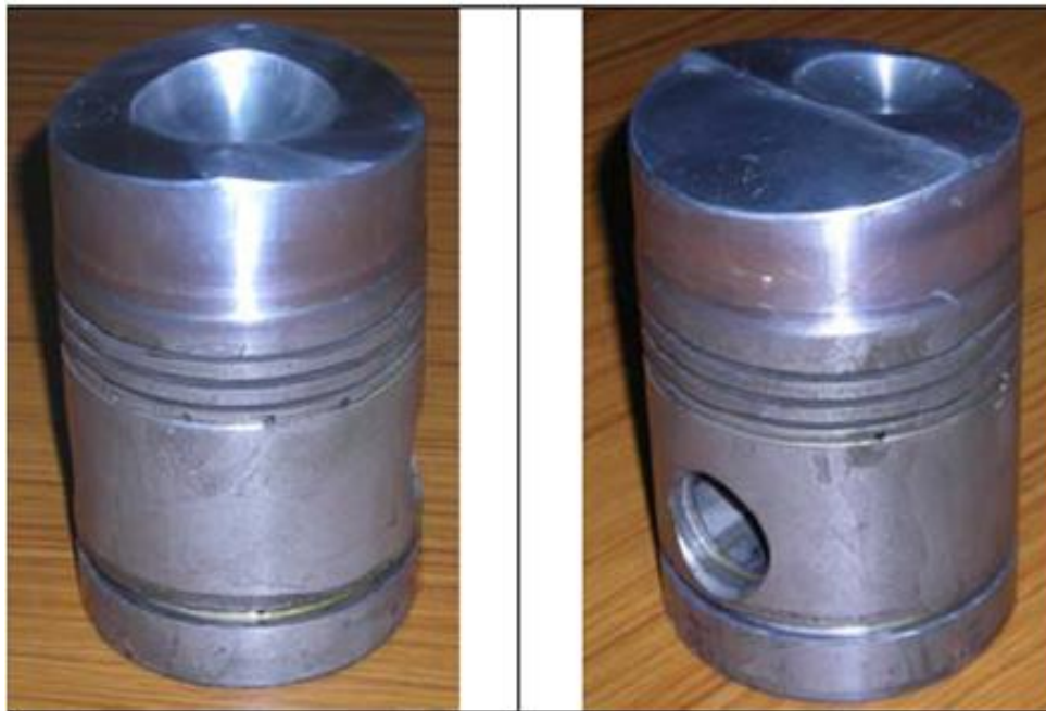
Hình 2.8: Pít-tông được tạo biên dạng lõm để tăng xoáy lốc ngang (Swirl)
