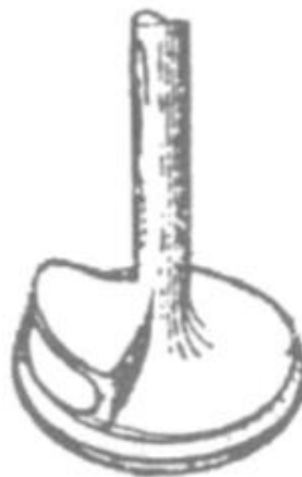
Hình 2.5: Xu-páp nạp được tạo rãnh để tạo xoáy lốc
