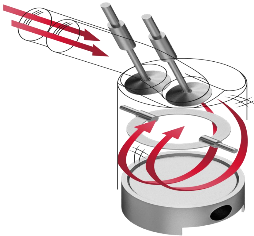
Hình 2.7: Xoáy lốc dọc (Tumble) được tạo ra khi xu-páp thường đặt nghiêng
