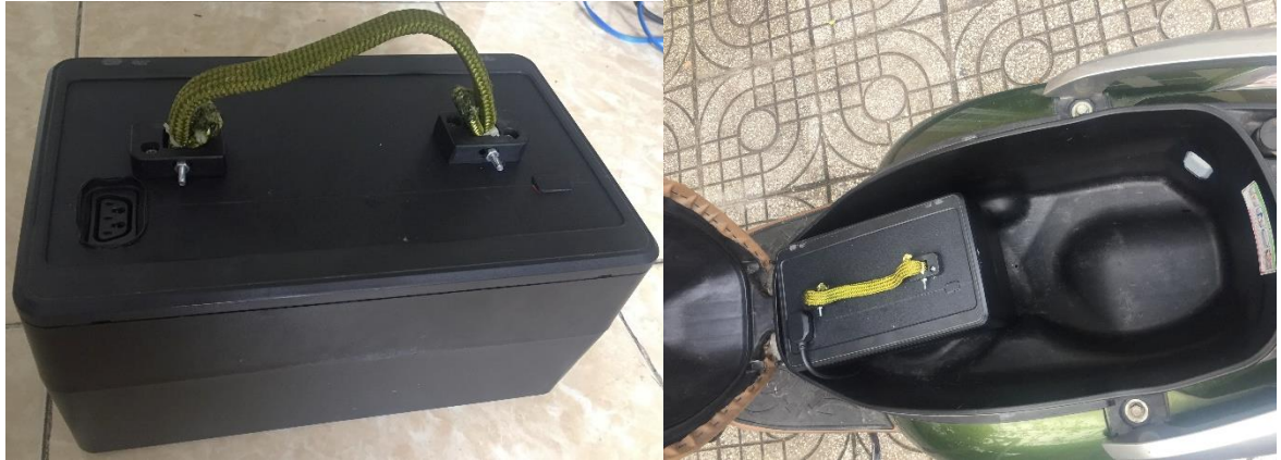
Hình 3.19: Bộ pin hoàn chỉnh và lắp lên xe
