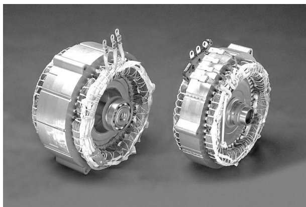
Hình 2.7: Động cơ điện xoay chiều cảm ứng trên Toyota Prius
