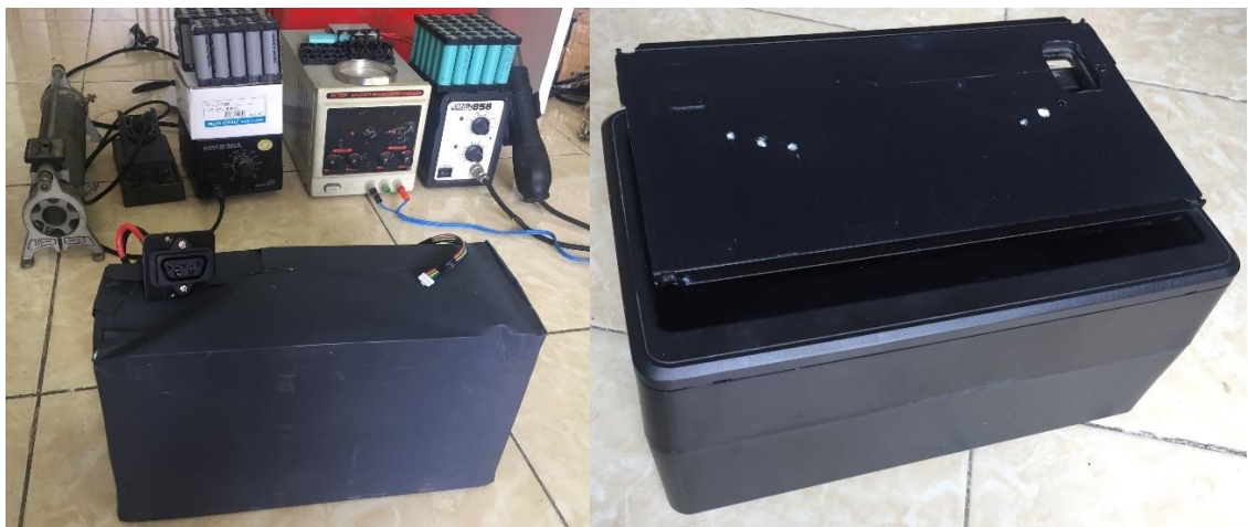
Hình 3.18: Bộ pin sau khi đóng gói và vỏ hộp
