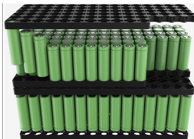
Hình 3.5: Ghép nối các cell pin lại với nhau bằng đế nhựa
