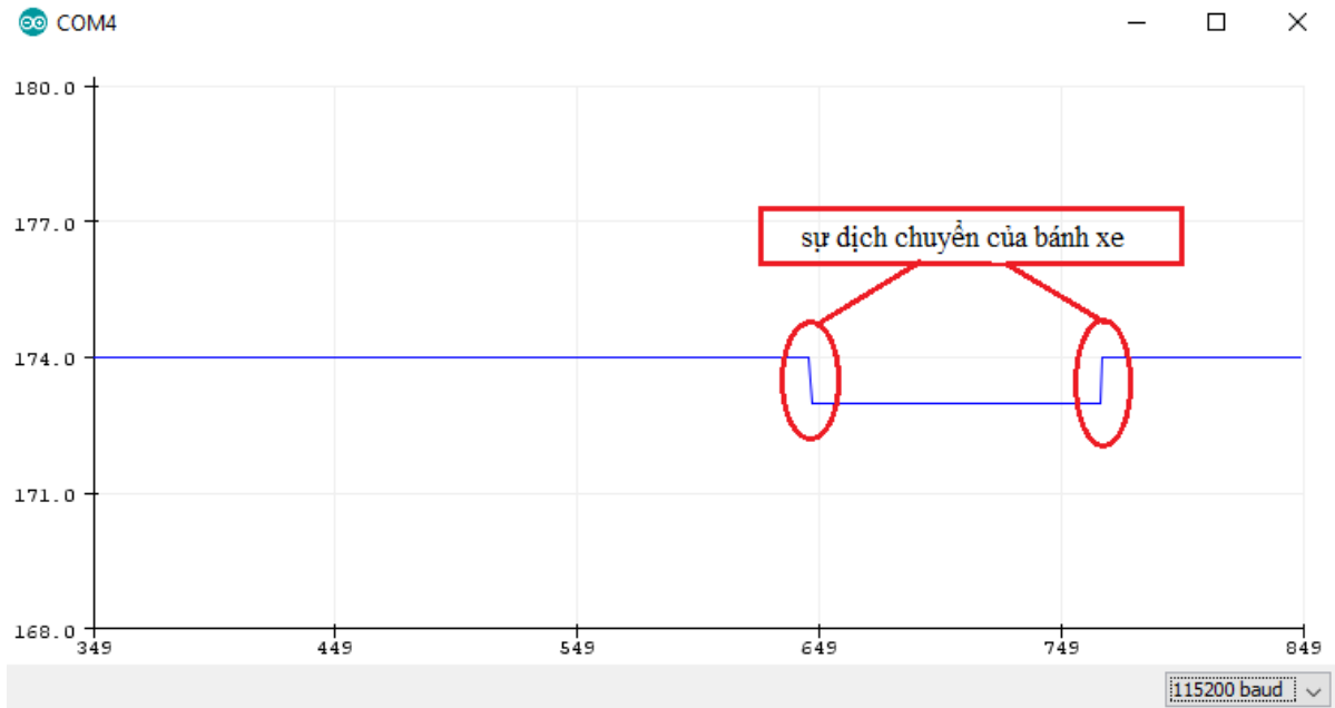
Hình 4.7: Tín hiệu cảm biến trả về khi bánh xe có sự dịch chuyển
