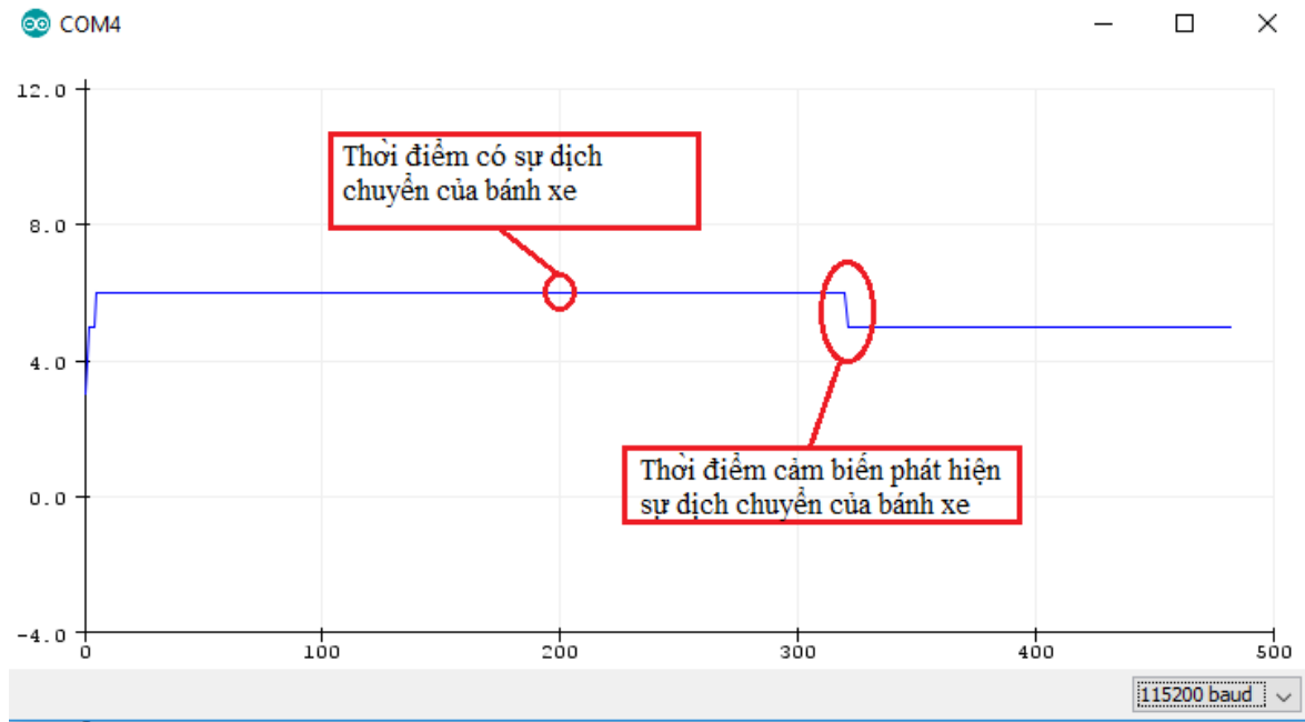
Hình 4.4: Tín hiệu trả về từ cảm biến siêu âm qua bộ lọc Kalman
