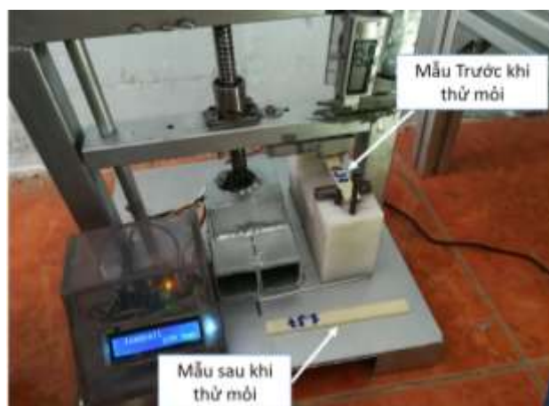
Hình 3. 6: Mẫu thử sau trước khi thử mỏi và sau khi thử mỏi
