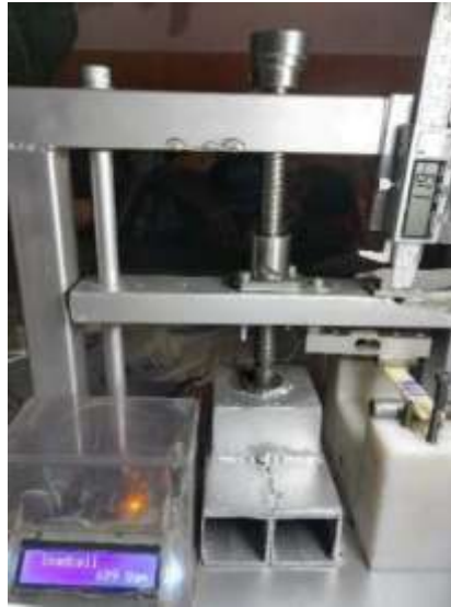
Hình 3. 5: Máy đo độ bền mỏi theo tải tác động
