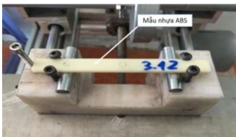
Hình 3. 2: Hình dáng thực tế mẫu thử theo tiêu chuẩn ASTM D790
